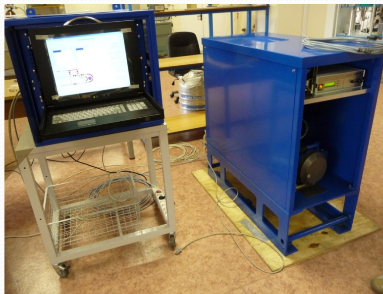
Установка контроля теплоносителя СЖГ-1001
