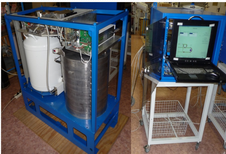
Установка контроля ИРГ СГГ-1002
